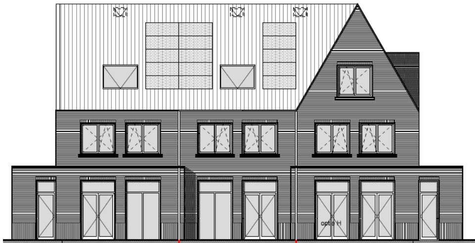
Achtergevel | zijuitbouw i.c.m. achteruitbouw / openslaande deuren
